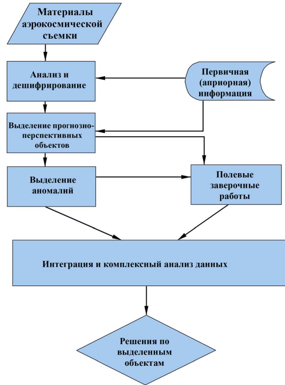
Рис. 1. Схема дистанционного поиска залежей углеводородов на суше
